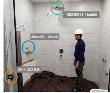
Şekil 3: Eczacıbaşı VitrA Kullanıcı Deneyim Laboratuvarı'nda kurulan sistem ve deneylerden bir görüntü.
